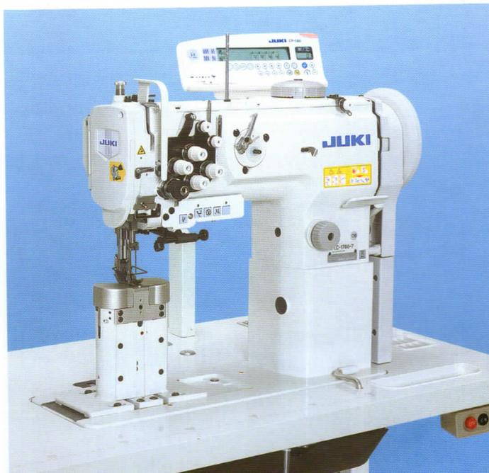
Esta máquina cuenta con un cortahilos y tiene un rendimiento básico ideal para coser materiales pesados como asientos de automóviles y muebles. Los trazos verticales de los prensateles (cantidad de movimiento vertical alternante de los prensateles) pueden cambiarse fácilmente usando el selector ubicado en la parte superior del cabezal de la máquina.
